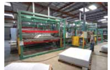
Termoformado de Acrílico y policarbonato para los domos prismáticos
